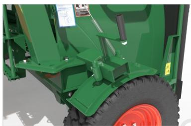
Frenos con zapatas sobre ruedas de accionamiento por rosca.
